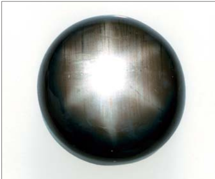
写真-1：鉛ガラスの含浸処理が施されたブラック・スター・サファイア
